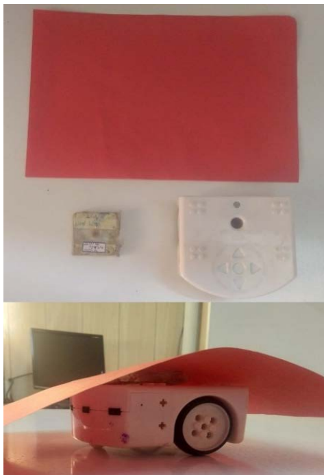
شکل ۴. به‌کارگیری ربات تیمیو جهت انجام آزمایش ثبت اطلاعات پرتوی به صورت پیوسته.
